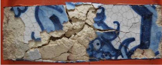
No final do ensaio o azulejo mostra perda significativa de vidro e chacota, acompanhada pela desagregação da chacota com rotura total. O empolamento da chacota é um artefacto provocado pela restrição à expansão livre imposta pela cintagem resultante da inserção na célula de envelhecimento.
